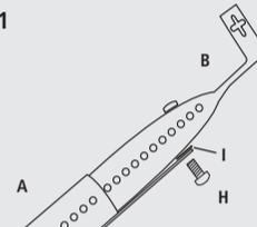
**3** Étend les pièces (A) et (B) pour adapter la longueur du brûleur précédent. Les pièces (A) et (B) doivent correspondre au bord pour que le boulon (H) peut sécuriser les deux brûleurs ensemble.
